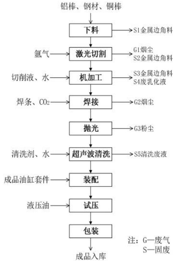
图2-4 现有项目生产工艺流程图
