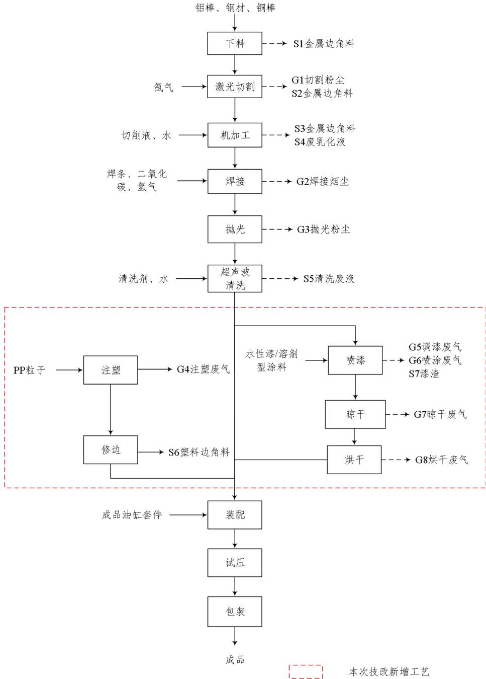
图 2-3 生产工艺流程图
