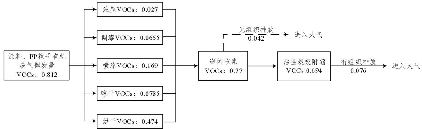
图 2-2 本项目 VOCs 平衡图 单位：t/a
