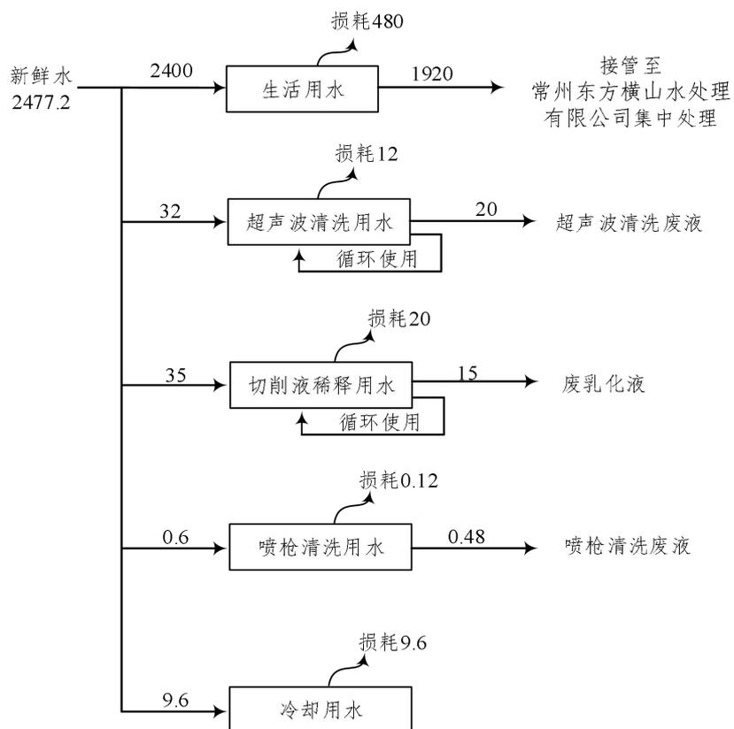
图 2-1 全厂水平衡图 单位 m<sup>3</sup>/a
